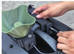
Prepojte rozmetadlo s batériovým modulom.
