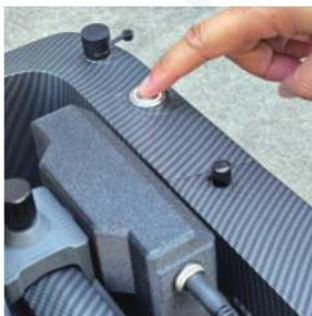
3. Zapnite loďku – spárovanie prebehne samo.
